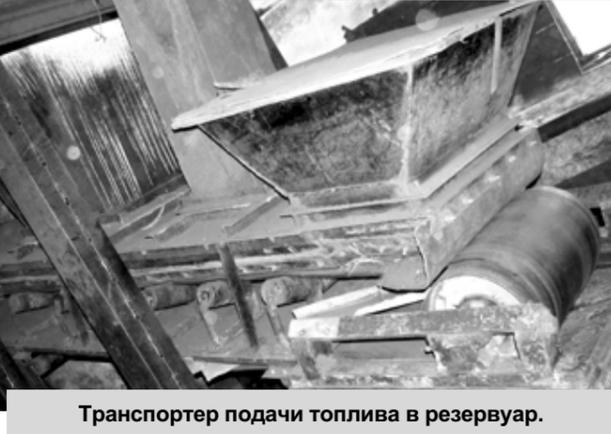
Транспортер подачи топлива в резервуар.
